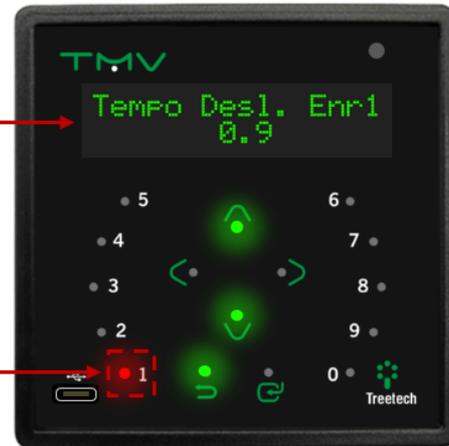
Figura 27 - Indicação de retardo para desligamento por temperatura do óleo ou enrolamento
