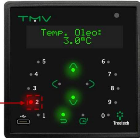
Figura 25 - Indicação de alarme por temperatura do óleo ou enrolamento
