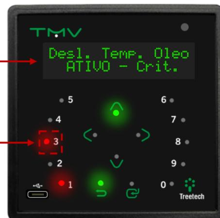
Figura 28 - Indicação de desligamento por temperatura do óleo ou enrolamento
