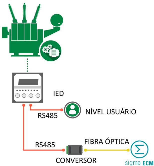
Exemplo de aplicação do **Smart Device para Monitoração de Temperatura SDT** com RS485.
