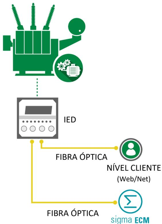
Exemplo de aplicação do **Smart Device para Monitoração de Temperatura SDT** com fibra óptica.
