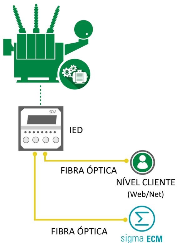
Exemplo de aplicação do Smart Device para Regulação de Tensão – SDV com fibra óptica.
