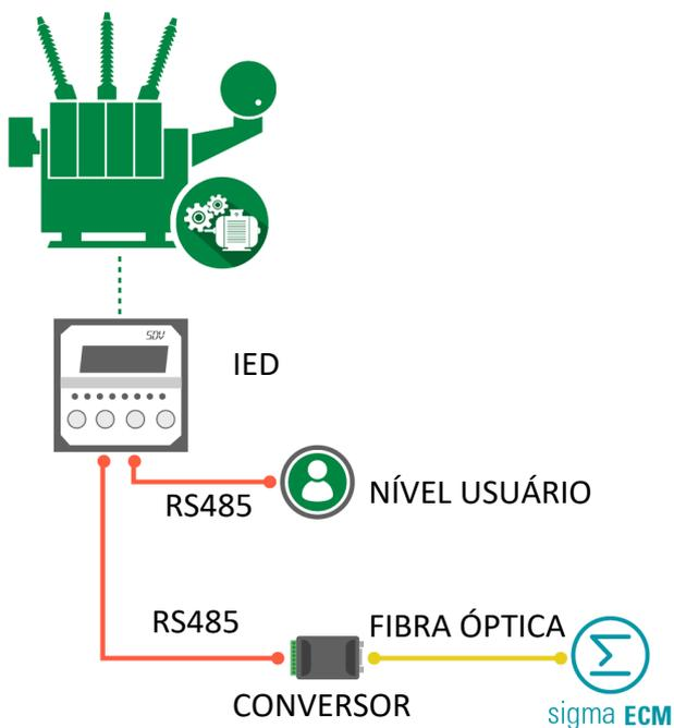
Exemplo de aplicação do Smart Device para Regulação de Tensão – SDV com RS485.
