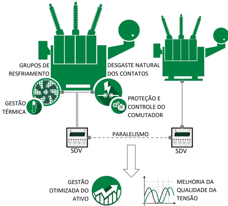
Exemplo de aplicação do **Smart Device para Regulação de Tensão – SDV.**
