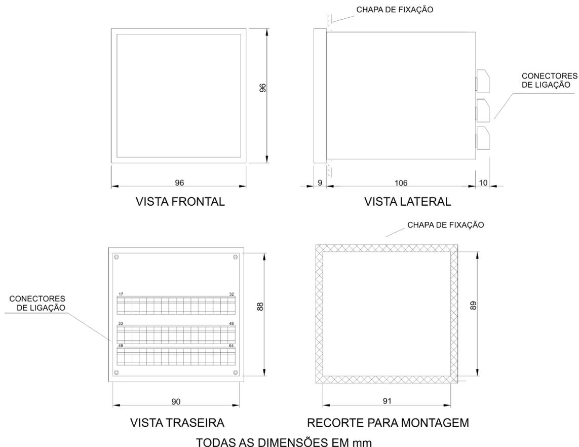
Figura 8 - Dimensões do TMV
