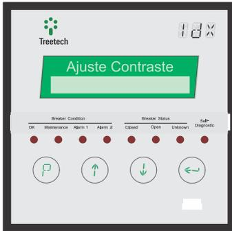
**Figura 18 – Ajuste do contraste do display**
